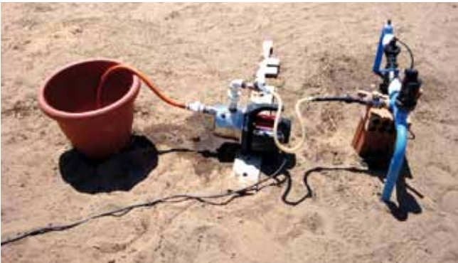
Figura 20. Esquema de montagem de um injetor elétrico.
