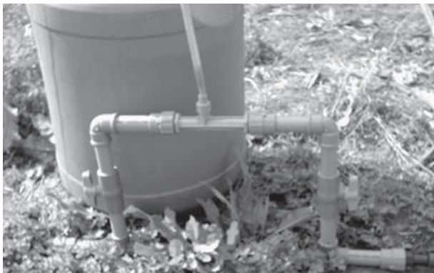
Cabeçal de irrigação (venturi) para injeção de fertirrigação orgânica.
