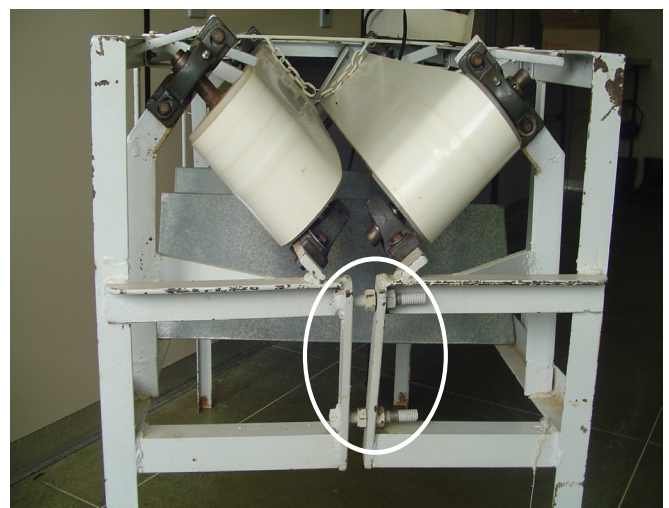
Fig. 6. Localização dos parafusos para ajuste do distanciamento entre as correias.
