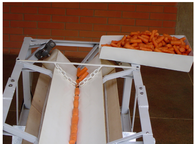
Fig. 3. Classificador de raízes inteiras, matéria-prima para Cenourete ou minicenouras processadas. Vista geral do equipamento (acima) e detalhe das calhas de classificação e abastecimento (abaixo).
