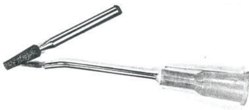
Figura 14 - Lâmina e rebolo para acabamento.
