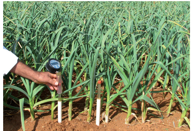
Figura 14. Tensiômetros instalados em duas profundidades para medição da tensão de água no solo com o uso de tensímetro digital.
