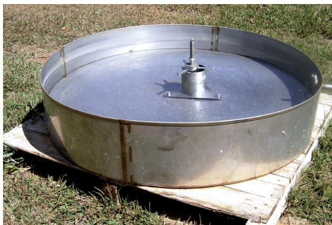
Figura 17. Tanque USWB classe A, com poço tranquilizador e micrometro de gancho, para medição da evaporação de água.
