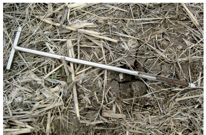
Figura 12. Trado tipo meia-cana para a amostragem e avaliação da disponibilidade de água no solo pelo método do tato-aparência.
