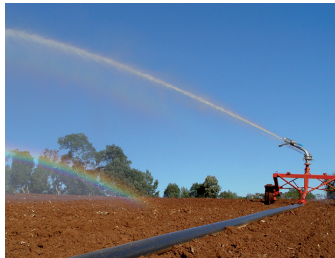
Figura 9. Carro irrigador de sistema de irrigação por aspersão tipo autopropelido.
