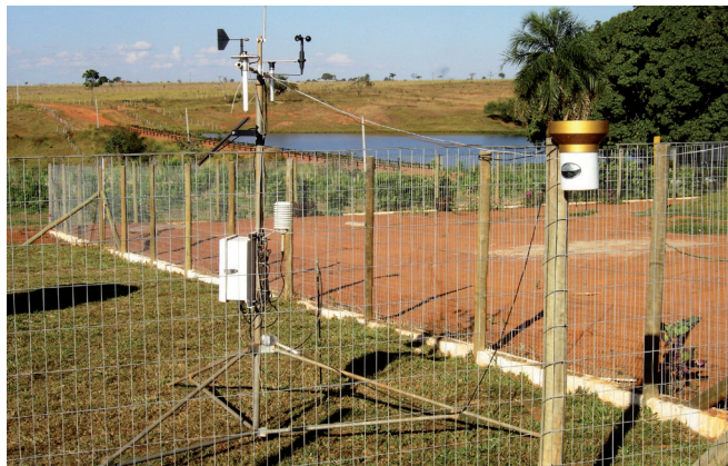
Figura 16. Estação agrometeorológica para medição das variáveis climáticas necessárias para a determinação da evapotranspiração de referência (ETo) pelo método de Penman-Monteith-FAO.
