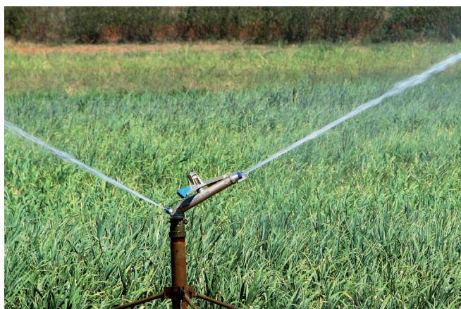
Figura 3. Detalhe de aspersor de impacto tipo canhão hidráulico instalado em sistema de irrigação por aspersão convencional.
