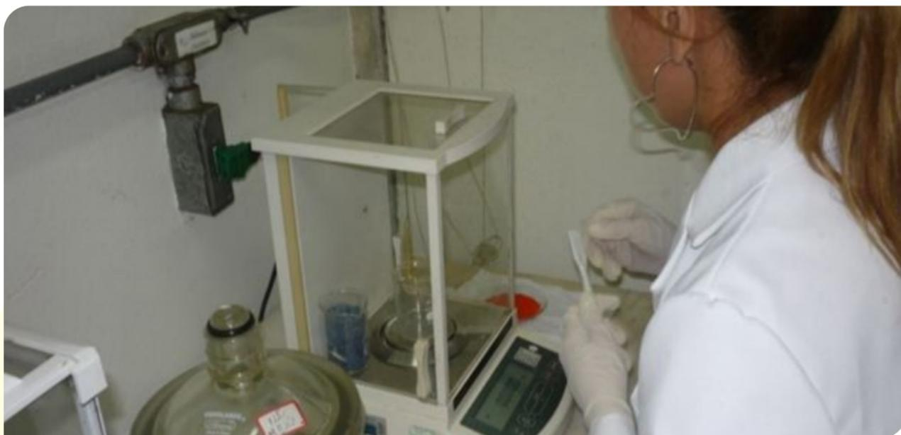
Figura 11. Amostras sendo pesadas em balança analítica.
