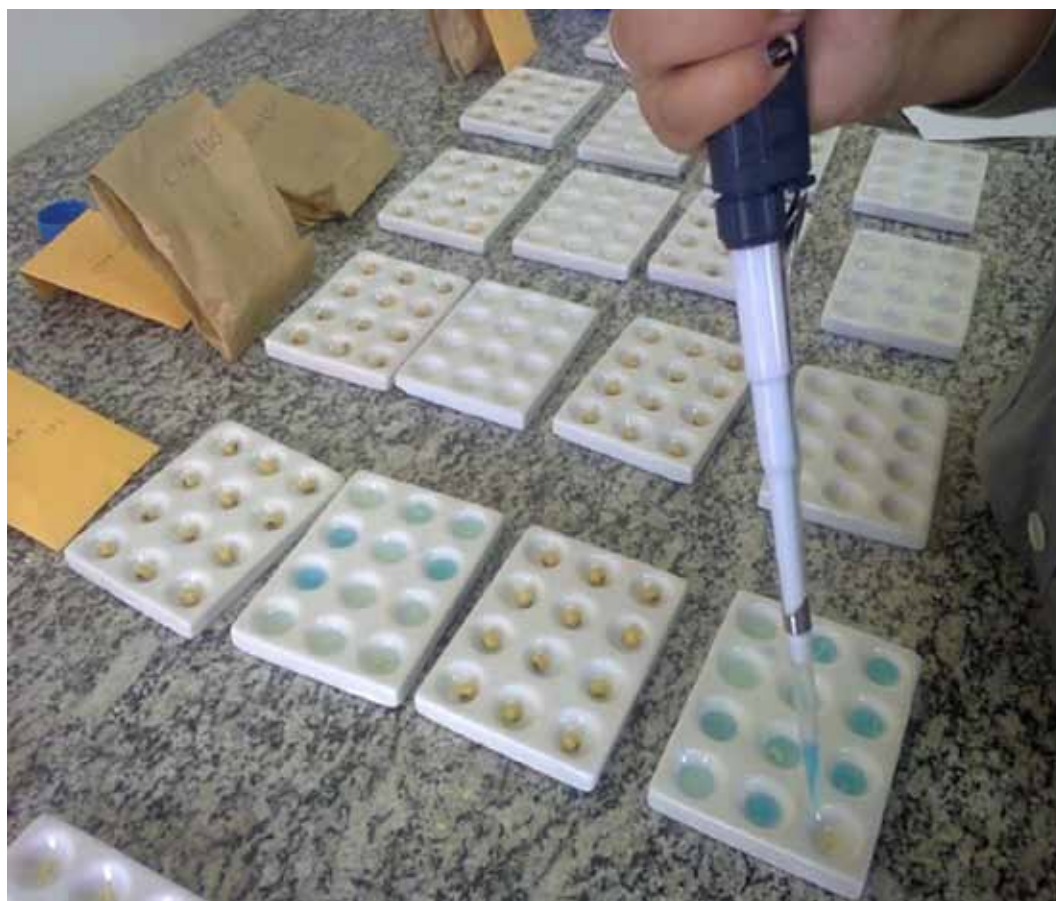
Fig.1. Análise qualitativa colorimétrica para determinação de presença das enzimas lipoxigenases L1, L2 e L3. Embrapa Trigo, 2013.
