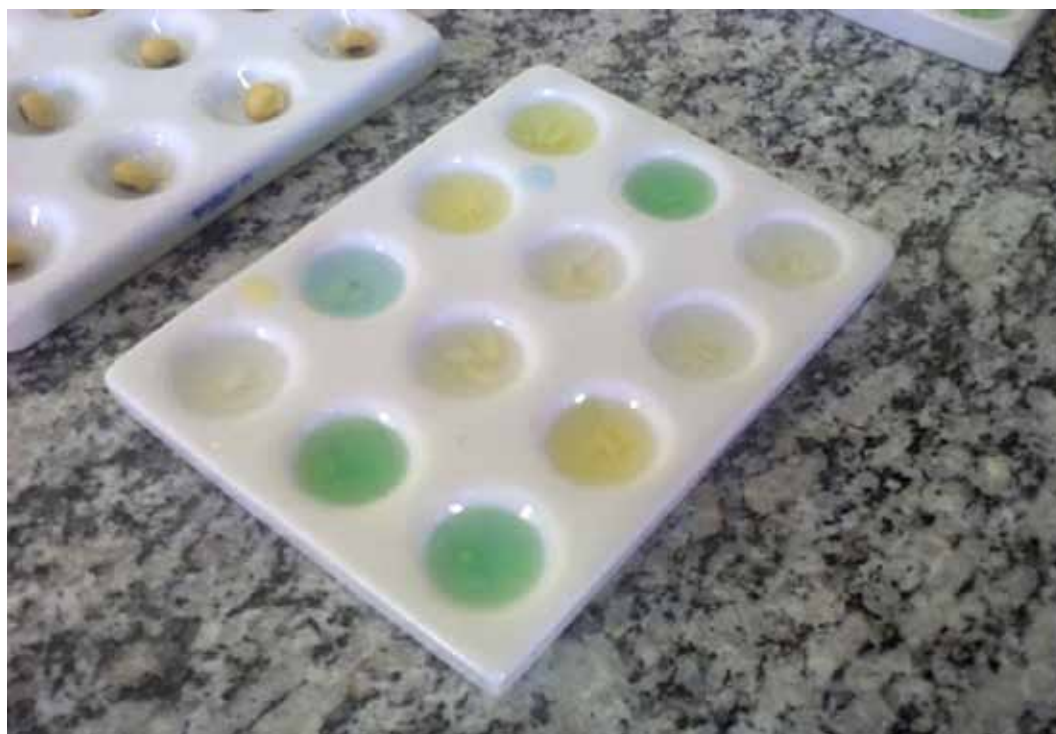
Fig. 2. Análise qualitativa colorimétrica para determinação de presença ou ausência das enzimas lipoxigenases. Verde: ausência de L1, L2 e L3; azul: ausência de L1 e L2; amarela: ausência de L3; e branca: presença de L1, L2 e L3. Embrapa Trigo, 2013.
