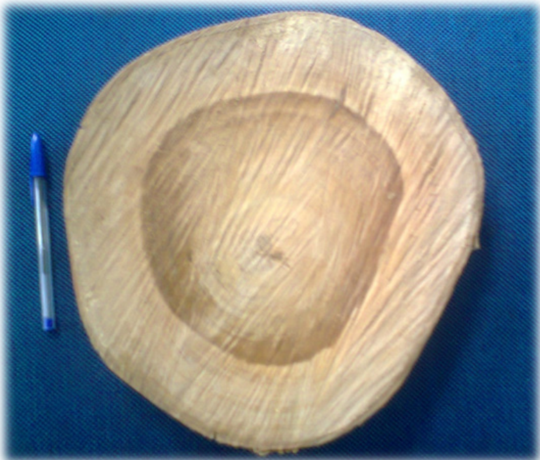
Figura 11. Corte radial de tora de madeira de Corymbia torelliana , com destaque para a diferenciação entre cerne e alburno.
