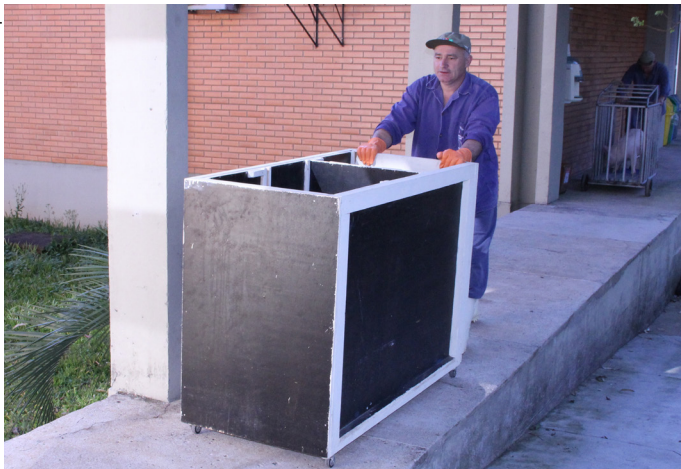
Figura 3. Exemplo de caixa de material isolante para contenção dos suínos para eletrocussão
