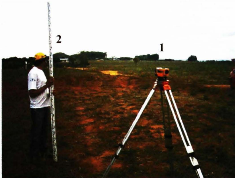
Figura 8: Nivel óptico (1) e mira vertical ou mira falante (2), (Cortesia de Deusimar F. de Freitas).
