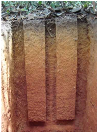
Figura 3. O macromonolito de solo é cuidadosamente esculpido (nesta trincheira foram esculpidos dois deles).
