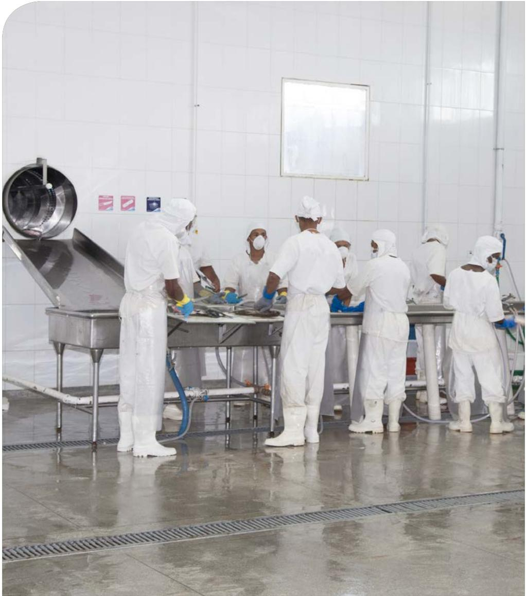
**Figura 7.** Salão de manipulação com piso antiaderente, paredes claras e revestidas de material impermeável. Equipamentos em aço inox.
