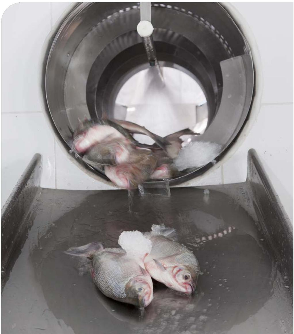
**Figura 30.** Saída do cilindro lavatório de pescados (área limpa).
