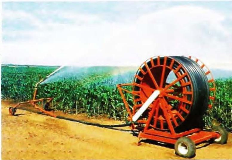
**Fig. 7.** Sistema de irrigação autopropelido com carretel enrolador e aspersor tipo canhão, em lavoura de milho-doce.
