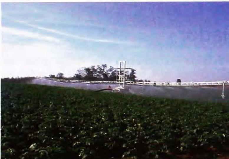
**Fig. 8.** Sistema de irrigação por aspersão autopropelido com barra irrigadora, em lavoura de batata.
