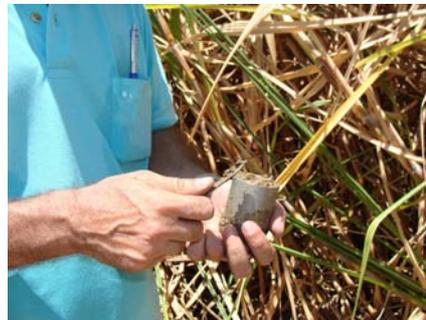
**Figura 2.** Detalhes da preparação da amostra obtida com anéis volumétricos de 100 cm<sup>3</sup>.
