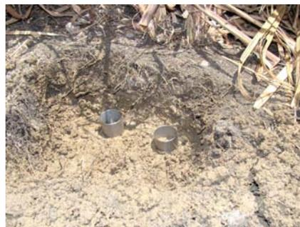
**Figura 1.** Fotos mostrando: (a) superfície do solo preparada para obtenção da amostra superficial de 0,00 a 0,05 m de profundidade; (b) minitrincheira de 0,25 m de profundidade com os anéis em posição para serem coletados.
