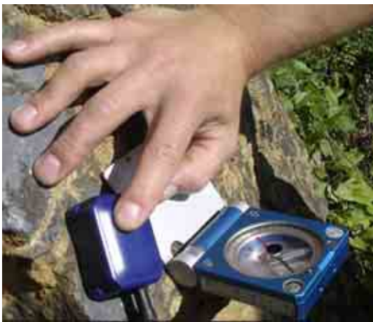
Abb. 6-4: Vergleichbare Messung eines herkömmlichen Geologenkompass mit dem neuen Sensor
