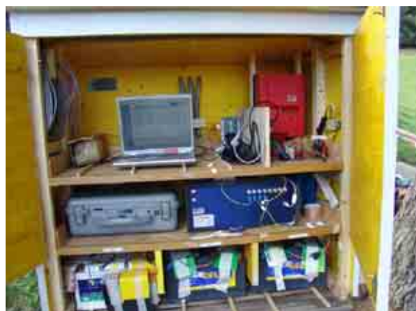
Abb. 4-17: a) SOFO-Messbox hinter Umzäunung Nähe eingebaute Strain-Rosette und b) geöffnete SOFO-Messbox mit Messinstrumenten
