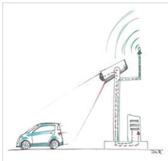
Die Erfassungs- und Kommunikationstechnik am Rand des Testfelds nimmt Geschwindigkeit, Position und Richtung der vorbeifahrenden Autos und Lkw auf und sendet diese Informationen an andere Fahrzeuge. So wird die Kommunikation zwischen Fahrzeugen simuliert.
