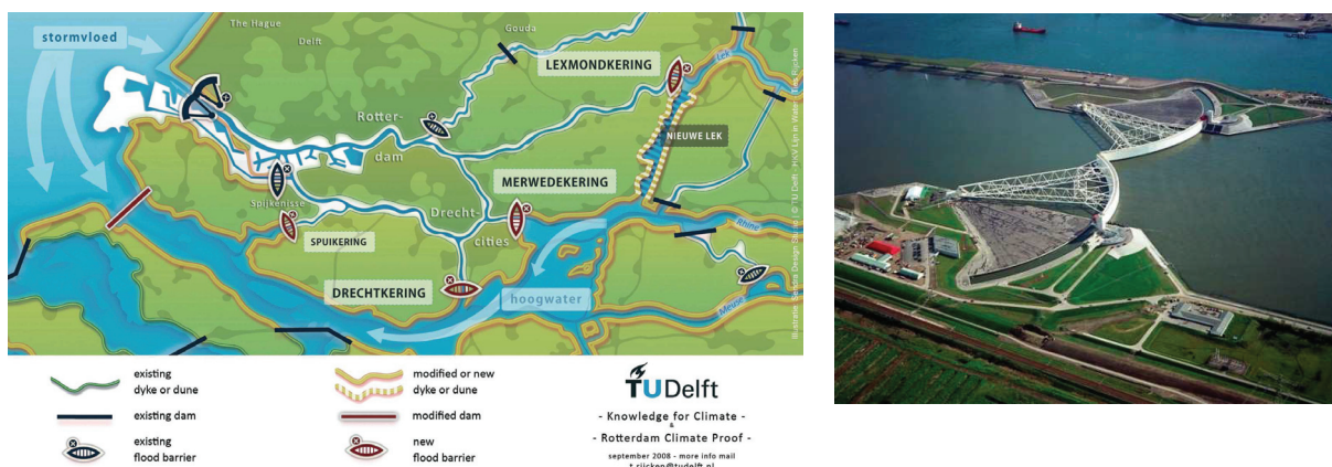
Abbildung 18: Illustration des integrierten Systemansatzes zum Überflutungsschutz in den Ästuaren von Rhein und Maas (aus der Studie „Rhine estuary closable but open – a multidisciplinary exploration“: s. Website Rotterdam Climate Initiative). Für die Zufahrt zum Hafen von Rotterdam wurde 2005 das Sturmflutsperrwerk Maeslantkering (Foto rechts und in der linken Abb. oben links dargestellt) am Hoek van Holland als Bauwerk des niederländischen Deltaplanes fertig gestellt. Es schützt den Rotterdamer Hafen und die unter dem Meeresspiegel liegende Region um Rotterdam (Quelle: http://www.rotterdamclimateinitiative.nl ).
