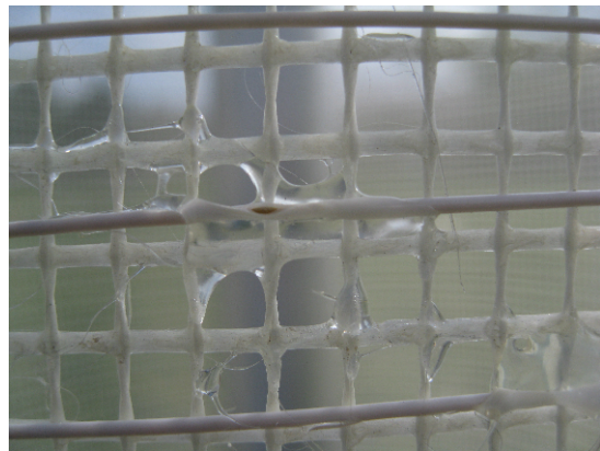
(d) Melted PVC-coating at a glue dot
