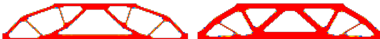
Abbildung 5-2: Optimierungsergebnis OC-Verfahren: Variante 1 (links), Variante 2 (rechts)
