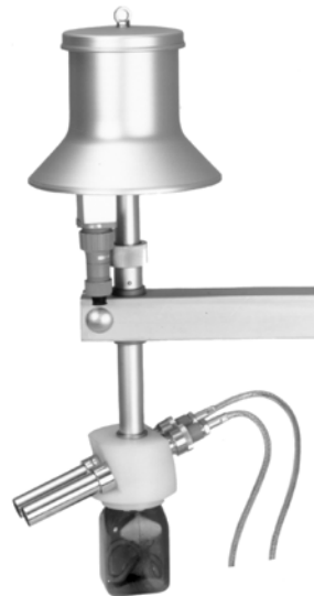
Abb. 2: Elektrisches Aspirationspsychrometer nach Frankenberger (Foto: Th. Friedrichs & Co.)
