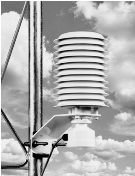
Abb. 1: Strahlungsschutzhütte für Temperaturmessungen (Foto: R.M. Young Company / GWU-Umwelttechnik GmbH)
