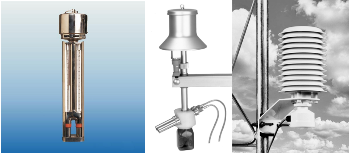
Abb. 1. Links: Aspirationspsychrometer nach Aßmann (Foto: Th. Friedrichs & Co.). Mitte: Elektrisches Aspirationspsychrometer nach Frankenberger (Foto: Th. Friedrichs & Co.). Rechts: Strahlungsschutzhütte für Temperaturmessungen (Foto: R.M. Young Company/GWU-Umwelttechnik GmbH).
