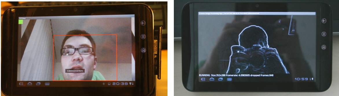
Abbildung 8.12: Abbildung der Streaming-Bildverarbeitungsapplikation für Android auf dem DELL Streak 7. ( Links : Gesichtserkennungsalgorithmus Rechts : Kantenerkennungsalgorithmus)
