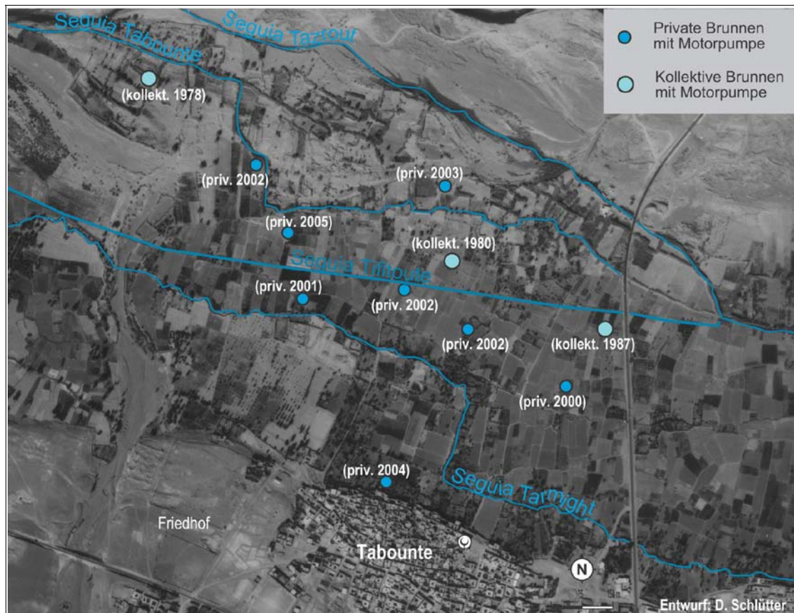
Abb. 48: Ausweitung der Motorpumpenbewässerung in Tabounte
