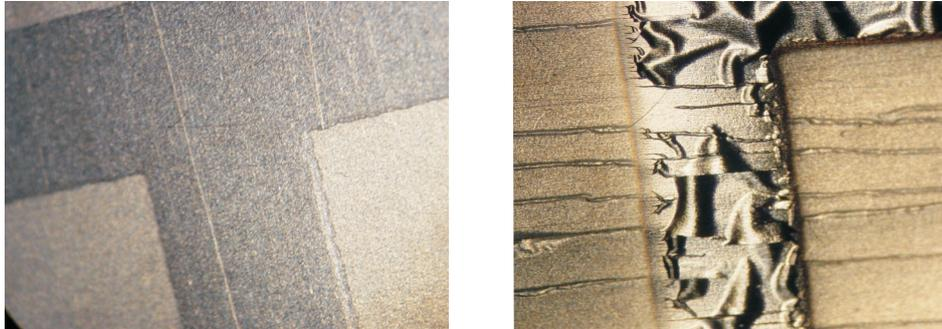
**Abbildung 3.3:** Vergleich zweier Aluminium-Elektrodenbahnen auf PVDF. Die linke Abbildung zeigt eine aufgedampfte Bahn, die rechte Bahn ist aufgestäubt (gesputtert). Man erkennt deutlich die Beschädigungen der rechten Bahn und die Knicke in der Folie.
