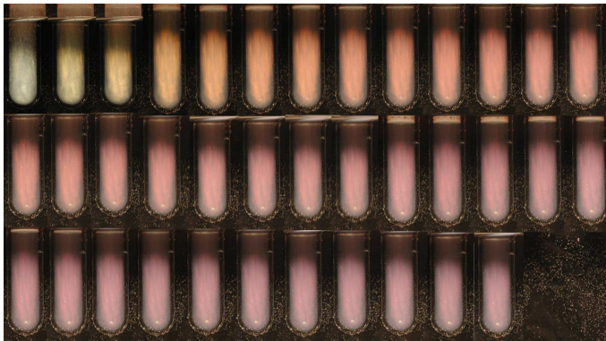
Abbildung 5.53: Zeitliche Entwicklung einer Schillerphase mit 0,7% MDS und [\text{Heptanol}]/[\text{MDS}] = 1,45 bei 25\text{ }^{\circ}\text{C} . Zeittakt der Aufnahmen: 30 s.
