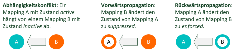
Abbildung 4.25: Primäre Propagationstrategien werden angewendet, um Abhängigkeitskonflikte innerhalb des Mapping-Modells aufzulösen.
