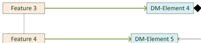
Abbildung 3.4: Abbildung von optionalen Features auf existenzabhängige DM-Elemente. Das Entfallen eines solchen Elements verletzt nicht die Wohlgeformtheit des DM .
