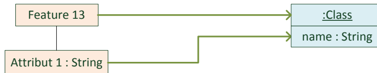
Abbildung 3.8: Manifestation von Feature-Attributen in elementaren Daten des Domänenmodells am Beispiel einer UML2-Klasse.
