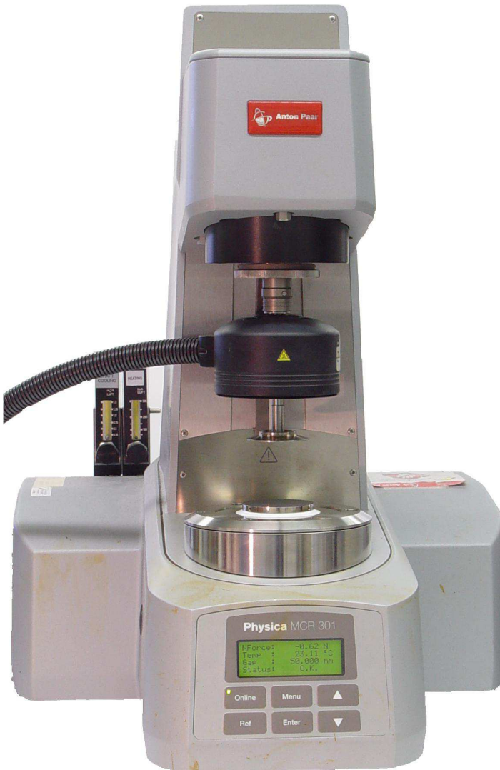
Abbildung 3.1: Rheometer Physica MCR 301 der Firma Anton Paar. Das Bild zeigt die Konfiguration mit dem verwendeten Kegel-Platte-Messsystem und der Abdeckhaube zur Temperaturstabilisierung (schwarz, Bildmitte).
