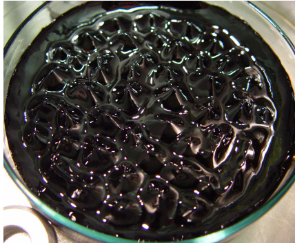
Abbildung 6.10: Die Normalfeld-Instabilität von FGSEPS bei einer Temperatur von 40 °C und einer magnetischen Flussdichte B = 26 mT.
