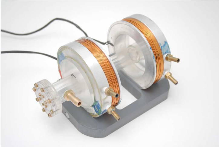
Abbildung 5.3: Foto des Separator-Aufbaus mit Messzelle und Maxwell-Spulen. Die Messinganschlüsse dienen dem Anschluss von Schläuchen zur Wasserkühlung beziehungsweise -temperierung von Spulen und Messzelle. Die beiden Kabel, oben links im Bild, dienen der Stromversorgung der Spulen.
