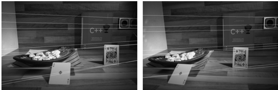
Abbildung 15: Epipolarlinien zum selbst erstellten Stereobildpaar. Die Fundamental-Matrix wurde aus zehn Korrespondenzen berechnet.
