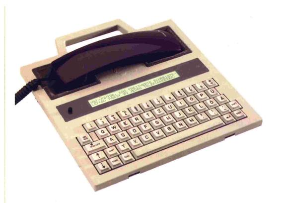
die der Text eingegeben wird und ein Display, auf dem die eigenen Nachrichten und die des Gesprächspartners erscheinen. Die Übermittlung erfolgt über die Telefonleitung. Zu diesem Zweck wird der Hörer eines normalen Telefons in die dafür vorgesehene Ablage des Gerätes gelegt.
