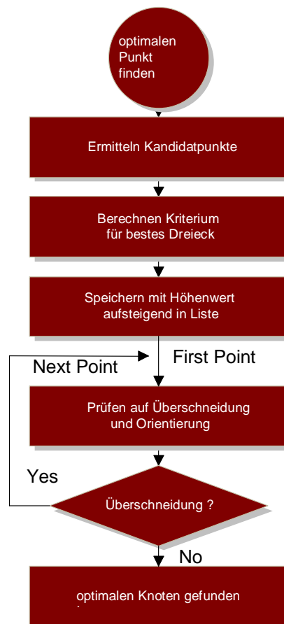
Abb. 7.12: Finden des optimalen Kandidatpunktes für die Triangulierung
