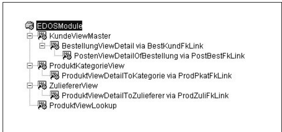
Abbildung 5-3 Die Struktur des Application Modules von „EDOS“
