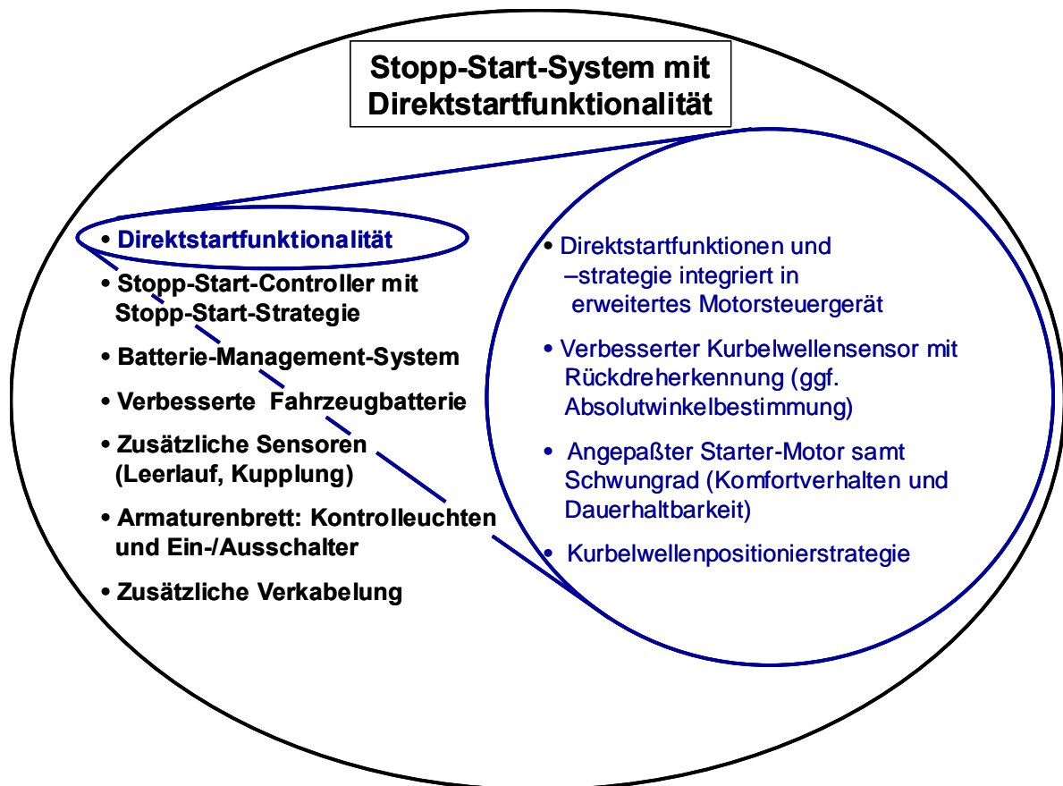
Bild 6-1: Bestandteile eines Stopp-Start-Systems mit Direktstarttechnologie
