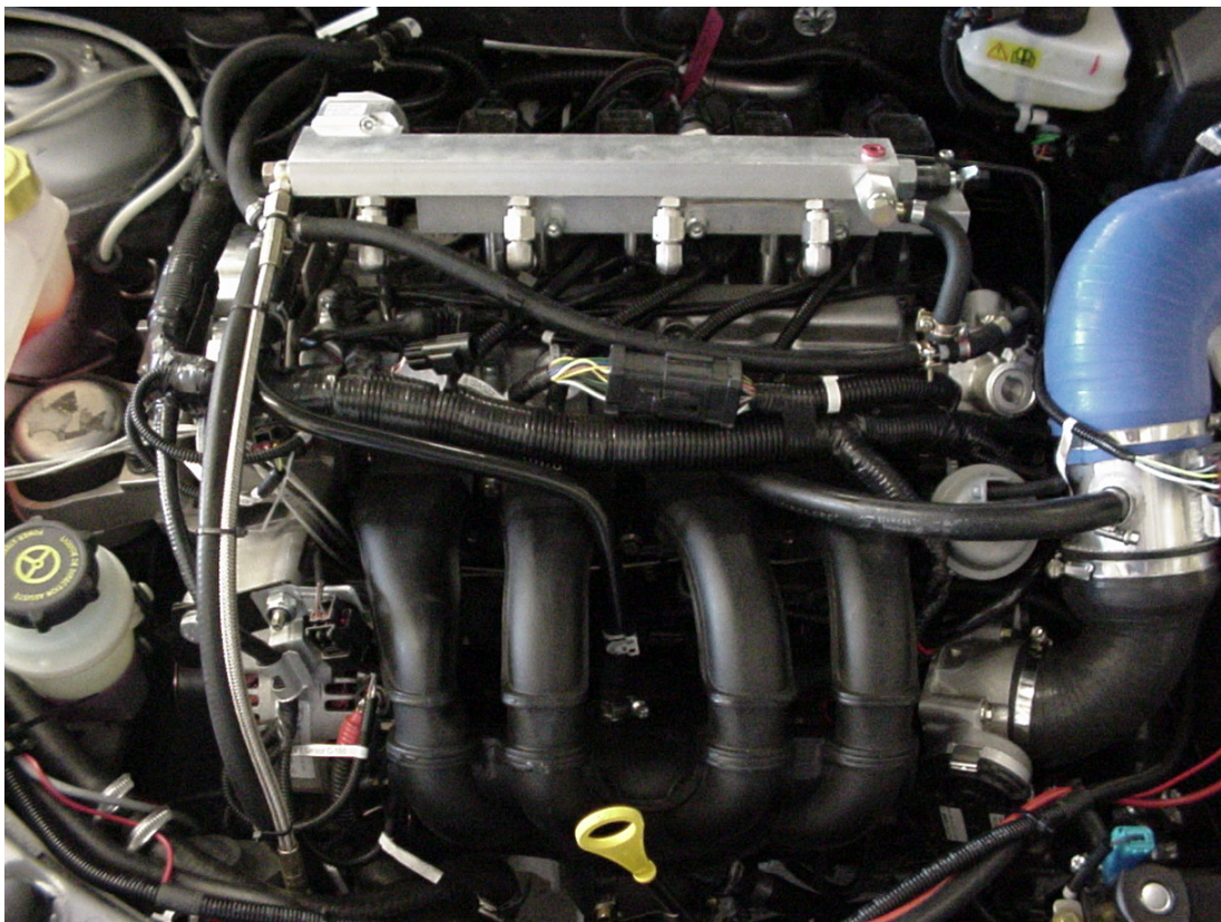
Bild 5.2.1-2: Versuchsmotor mit strahlgeführter Benzindirekteinspritzung
