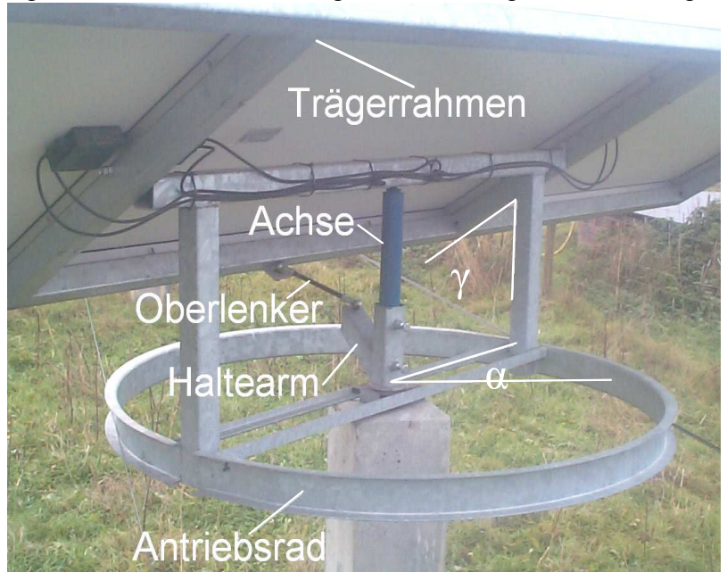
Abbildung 6.2: Nachführungsmechanismus der Modulträger
