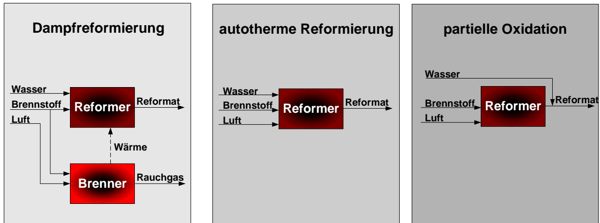
Abbildung 4.17: Verfahren zur Reformierung von Kohlenwasserstoffen. Grafik entnommen aus [4-MAT02]
