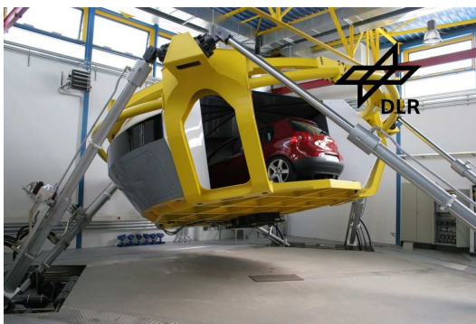
Abbildung 4.21: Fahr Simulator am DLR Braunschweig auf der Basis eines SSM (© Photo DLR Braunschweig)
