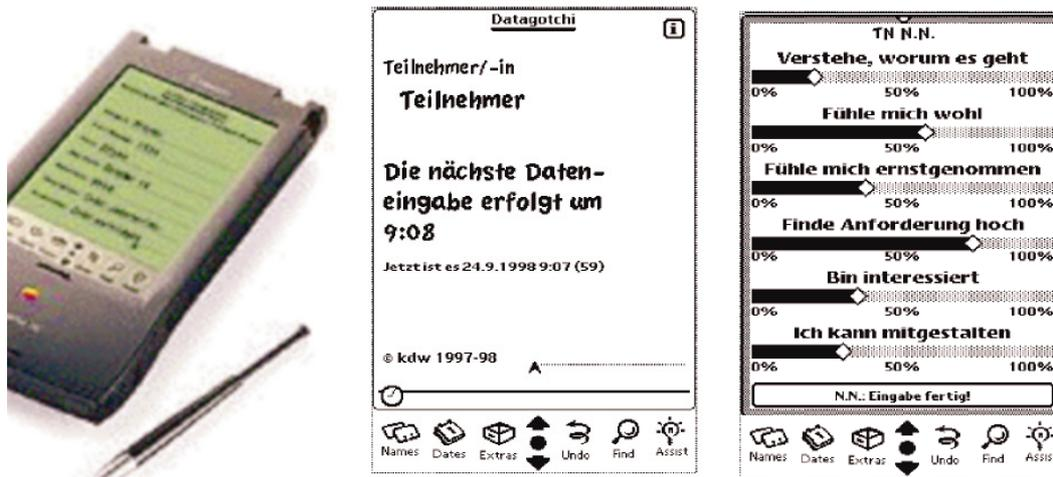
Abbildung 13: Mobiles Endgerät für die Datenmessung während eines Lernprozesses
