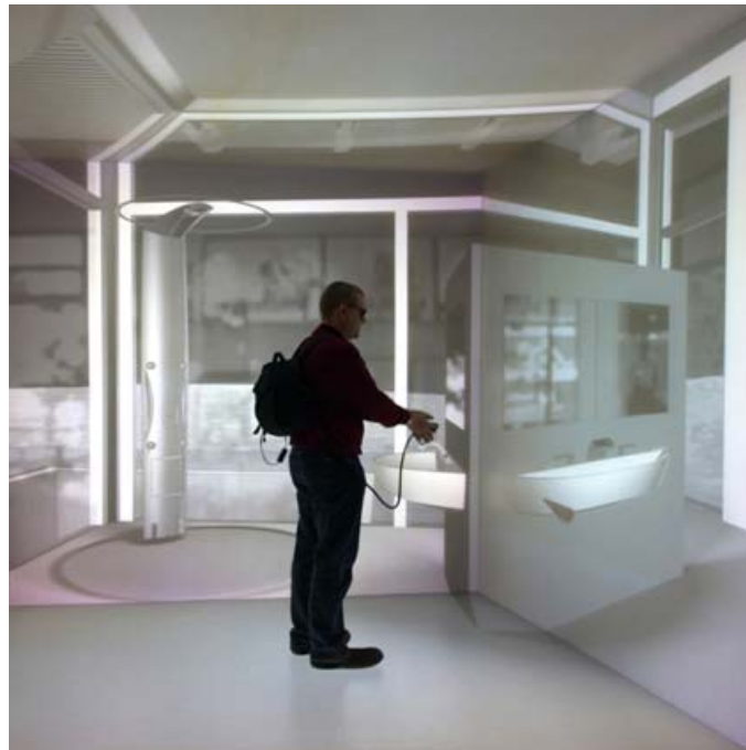
Abbildung 2-17: 6-Seiten-CAVE HyPi-6 [Fraunhofer IAO]
