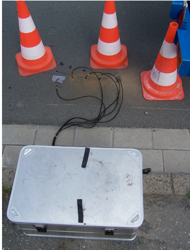
Foto 4-1: Aufbau der mobilen Temperaturmessstation
