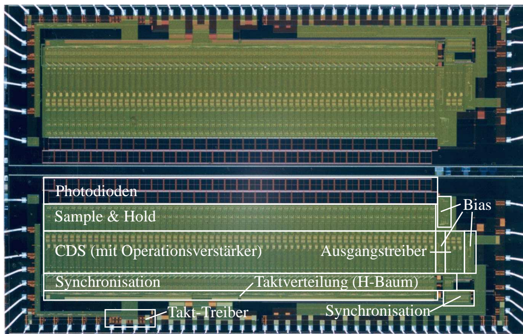
Abbildung 7.17: IC-Photo zweier 2 \times 32 -Pixel Zeilensensoren
