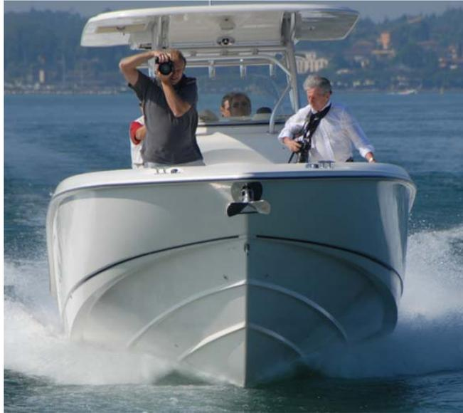
Abbildung 11-5: Deutlicher Abriss der Querströmung
