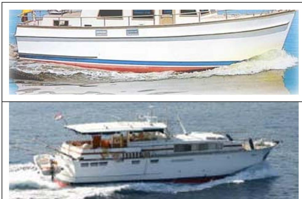
Abbildung 11-2: Typischer Wellenverlauf eines Verdränger-Rumpfes
