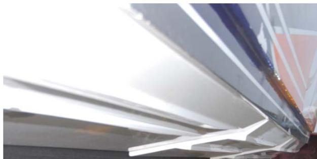
Abbildung 2-15: Scharfkantig ausgeführte Spritzwasserkante bzw. Strake
