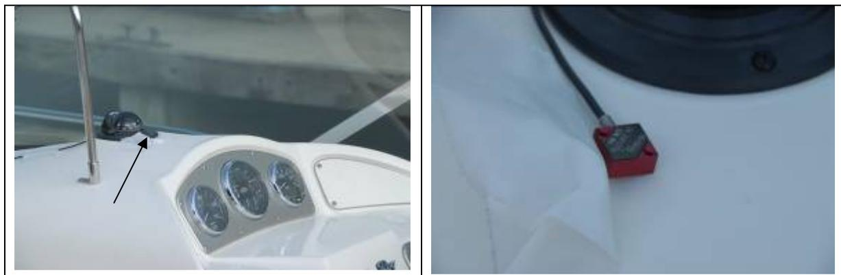
Abbildung 7-15: Lage des Beschleunigungssensors am Fahrerplatz
