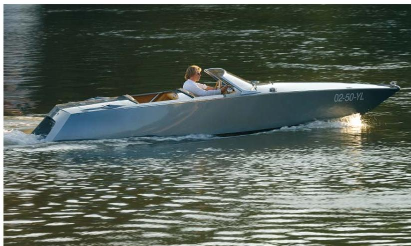
Abbildung 11-7: Verdrängerfahrt eines Gleitrumpfbootes [42]
