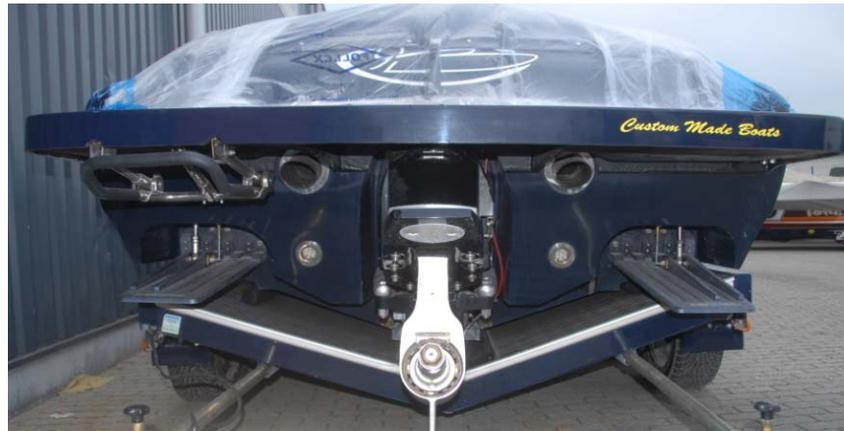
Abbildung 11-8: Seitliche Trimmklappen eines typischen Renn-Gleittrumpfes
