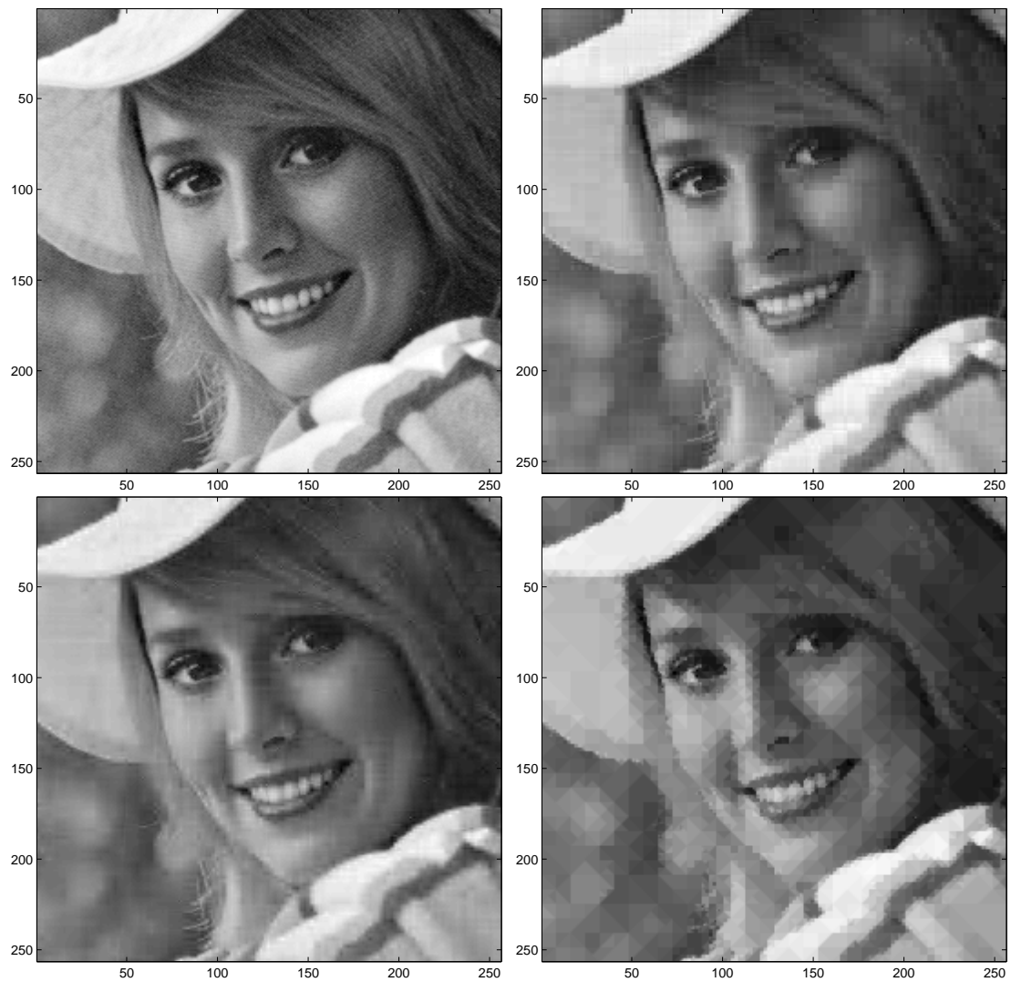
Abbildung 2.4: Approximation des „Elaine“-Bildes mit 3.277 Koeffizienten. (a) Originalbild, (b) Tensor-HWT, PSNR 29.68 dB, (c) Tensor-D4, PSNR 30.81 dB, (d) Gerichtetete HWT, PSNR 29.20 dB.
