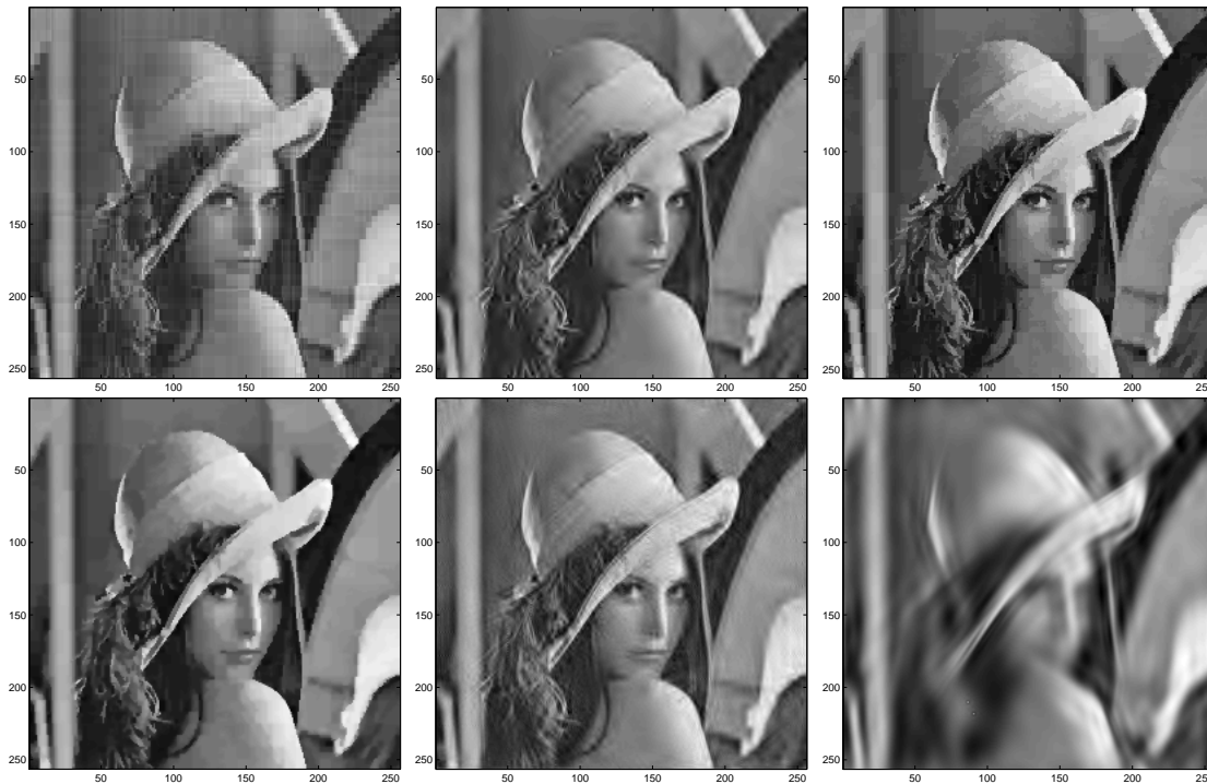
Abbildung 3.10: Approximation des „Lena“-Bildes mit 2048 Koeffizienten. (a) Klassische HWT, (b) Biorthogonal 9-7, (c) Tetrolets, (d) Tetrolets BF, (e) Contourlets, (f) Curvelets.
