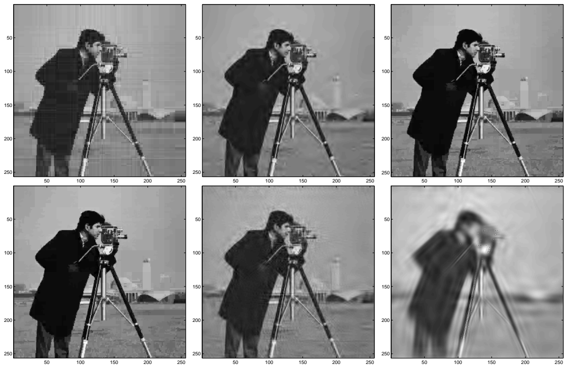
Abbildung 3.8: Approximation des „cameraman“-Bildes mit 2048 Koeffizienten. (a) Klassische HWT, (b) Biorthogonal 9-7, (c) Tetrolets, (d) Tetrolets BF, (e) Contourlets, (f) Curvelets.
