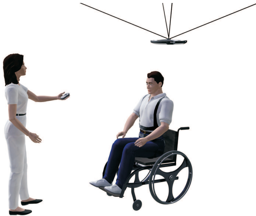
Abbildung 8.12: Physio-Seilroboter in Variante „Halo“ als Aufsteht- und Setzhilfe. Quelle: [92]
