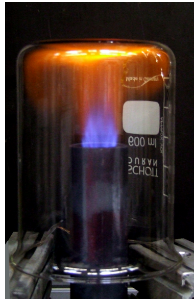
Bild 6.31: Flammenausbreitung in Glaszylinder, Flammenbrenner, P = 2,55 \text{ kW}
