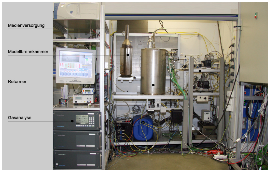
Bild 6.2: Foto des Teststandes mit Modellbrennkammer und Reformer
