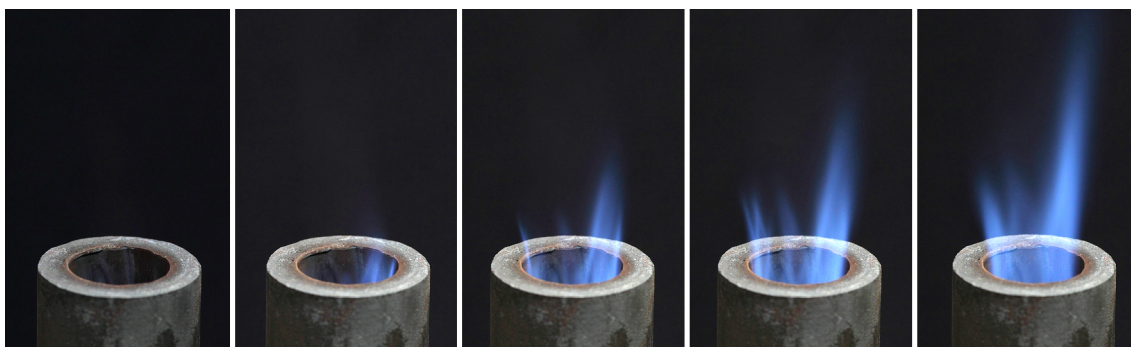
Bild 5.5: Flammenbrenner, CH 4 , Leistungsstufen 0,5 - 1,0 - 1,5 - 2,0 und 3,0 kW
