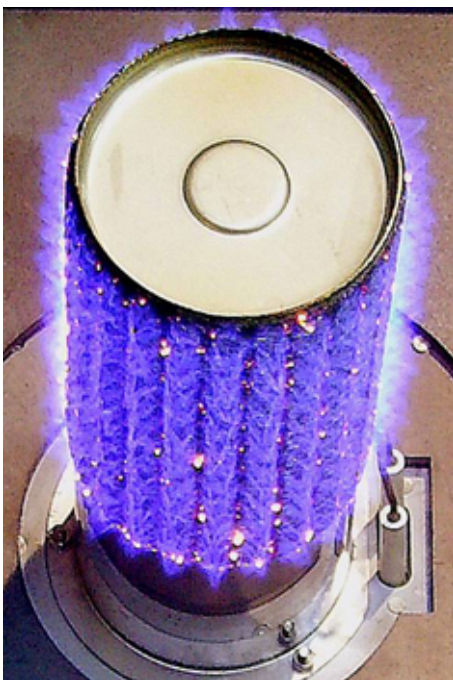
Bild 4.4: Metallfaser Brenner, ca. 15 kW [46]
