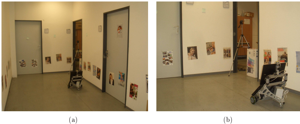
Abbildung 6.4: Für die Experimente verwendeter Flur: (a) Weitaufnahme des Flurs; (b) Nahaufnahme des Roboters und der verwendeten UEye-Kamera auf dem Stativ.
