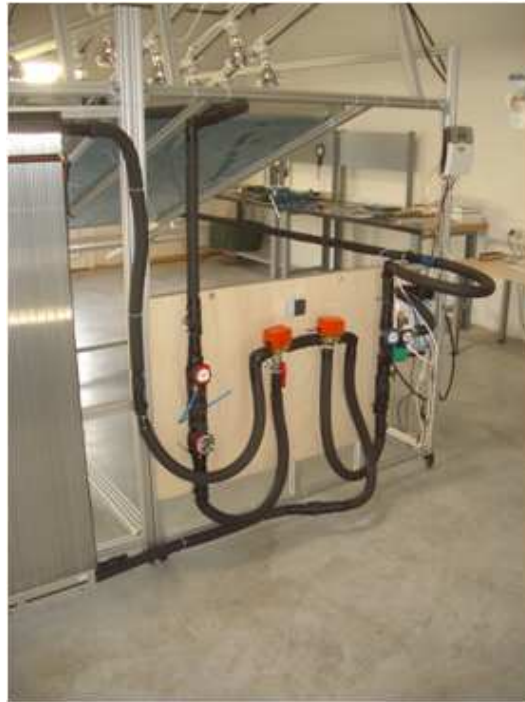
Abb. 5.15: Aufbau des Prüfstandes: Heißzweig, Kaltzweig und 3-Wege-Ventile.
