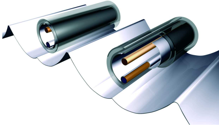
Abb. 3.4: Aufbau eines Vakuum-Röhrenkollektors [54].
