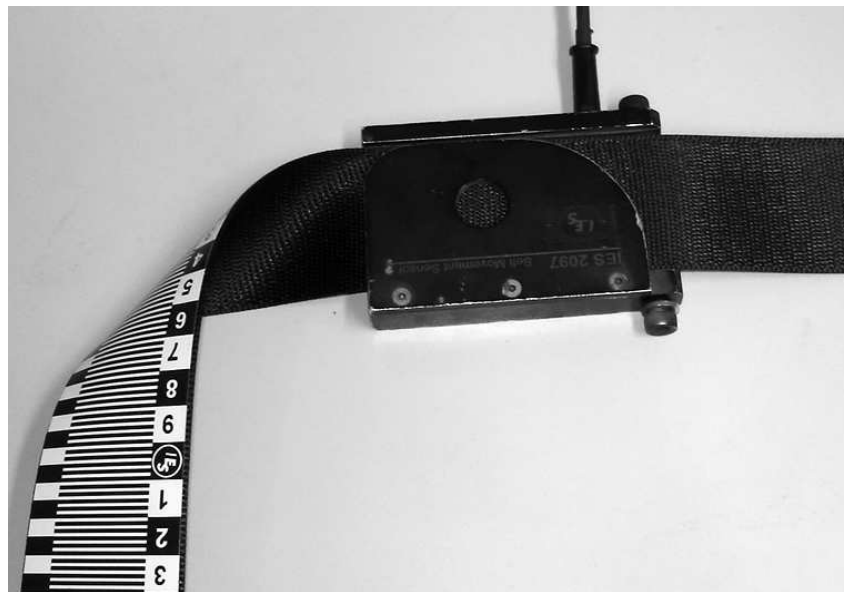
Abbildung 6.7: GAZ IES 2097 mit aufgeklebtem Messstreifen [67]
