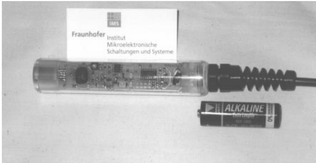
Bild 4.17: Demonstrationsmuster des Kleinstpotentiostaten.
