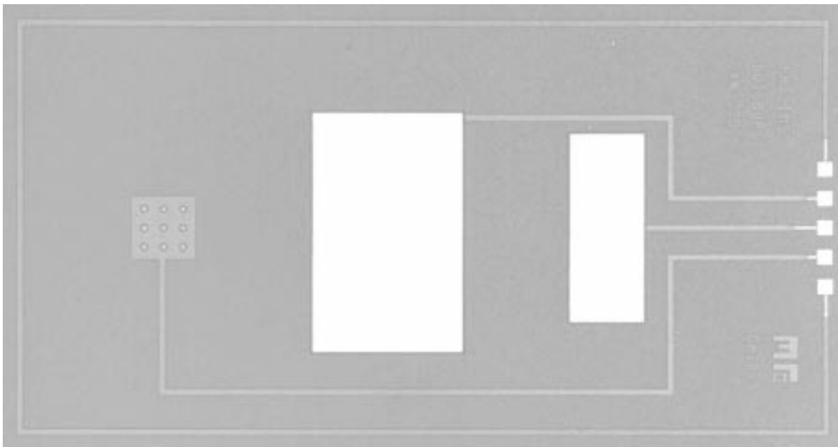
Bild 1.5: Subchip 5 aus VC283. Dieses Layout wurde auch für die Subchips 4 und 6 verwendet. Die äußeren Abmessung betragen 3,5 \times 6,5 \text{ mm}^2 .
