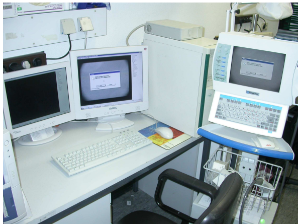
Abb. 10: Arbeitsplatz zur Messung der hepatischen Mikrozirkulation. Links neben dem CytoScan® stehend der selbstkonfigurierte Aufnahme-PC mit angeschlossener mobiler Festplatte auf dem Computergehäuse und Dual-Monitor-Betrieb.
