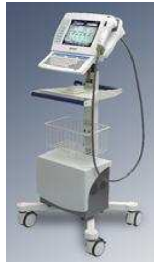
Abb. 4: CytoScan® Video-mikroskop. (Quelle: www.lekam.co.uk)
