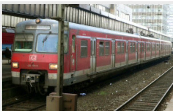
Abb. 25: Nahverkehrstriebwagen der Baureihe 420. Obwohl bereits in den 1960er Jahren entworfen, sind die Züge, vermutlich auch aufgrund von Nachrüstungen, sehr leise bei der Einfahrt in den Bahnhof.
