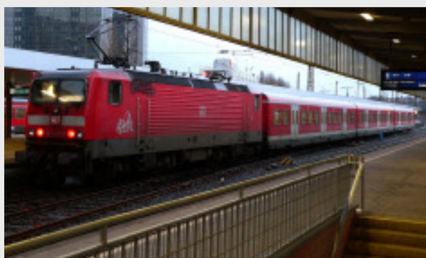
Abb. 24: Standardfahrzeug auf den S-Bahnlinien im Verkehrsverbund Rhein-Ruhr (VRR) sind die Gespanne mit Lok 143 und speziellen Niederflur-Reisewagen: der „S-Bahn-Wendezug Rhein-Ruhr“.
