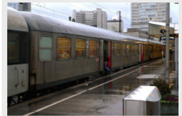
Abb. 27: Ein Nahverkehrsbus mit einstöckigen (solo) Nahverkehrswagen. Abgebildet ein sogenannter „Silberling“ in Originalgestalt, nämlich ohne Lackierung. Diese Wagen sind veraltet, werden aber auch heute noch benutzt (Aufnahmedatum: Februar 2007). Ihre Bremsen erzeugen verhältnismäßig laute, tonhaltige Geräusche.
