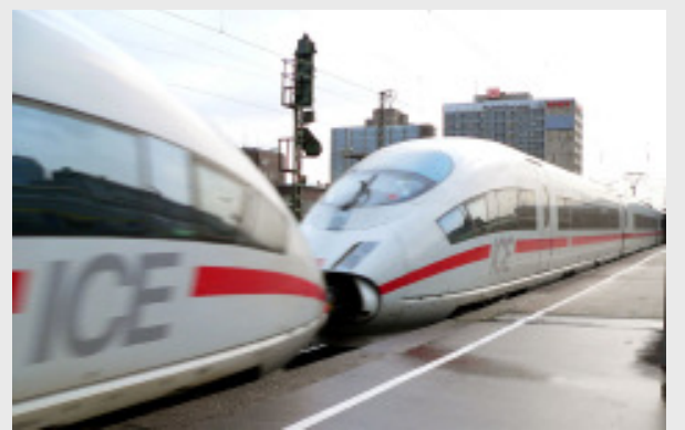
Abb. 31: Der ICE 3 ist das Flaggschiff der Deutschen Bahn und kann routinemäßig 300 km/h erreichen. Oft werden zwei vollständige Einheiten dieser Triebwagen miteinander kombiniert (wie hier abgebildet), woraus Züge von mehreren Hundert Metern Länge entstehen. Vielleicht ist der Grund für die von uns festgestellten hohen Schallpegel bremsender Fahrzeuge dieses Typs in den notwendigerweise besonders leistungsfähigen Bremsen zu suchen.
