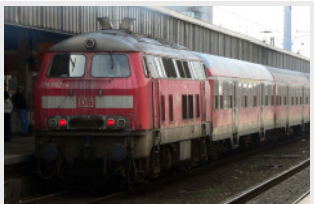
Abb. 26: Die Diesellok-Gespanne mit Lokomotive der Baureihe 218 und alten (modernisierten) Nahverkehrswagen waren technisch gesehen wahrscheinlich die am ehesten veralteten Fahrzeuge im Regelbetrieb der Bahn im Raum Essen. Sie sind mittlerweile (Frühjahr 2007) nicht mehr im Einsatz. Rollgeräusche und Endbremsen waren verhältnismäßig lärmintensiv. Dies galt auch für die Geräuschentwicklung beim Anfahren der Lokomotive, das Diesellaggregat machte dann erheblichen Lärm, der allerdings eher seitlich, nicht nach unten, abstrahlte (empfindliche Bahnsteigpassanten schützten dabei ihre Ohren).
