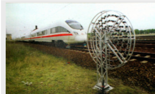
Abb. 20: Lärmmessung auf freier Strecke bei einem ICE. Beachte die aufwändige, spiralförmige Mikrofonbatterie. (aus WILLE et al. 2005)
