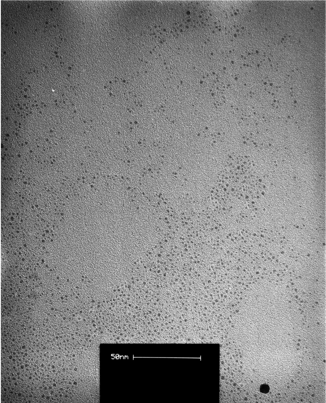
Abb. 48: TEM-Aufnahme eines Films aus \text{Au}_{55}(\text{PPh}_3)_{12}\text{Cl}_6 . (Übertragen mit einer Geschwindigkeit von 1 mm/min, Temperatur 20^\circ\text{C} , \pi = 20 \text{ mN/m} ).
