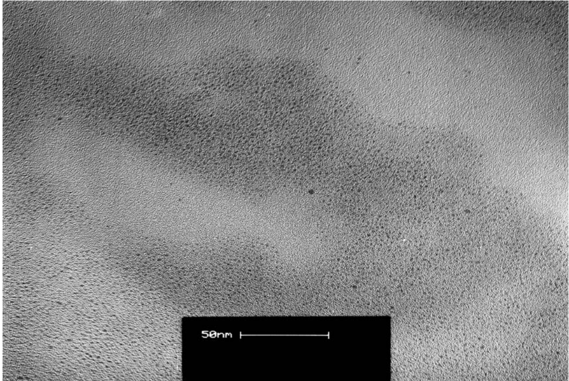
Abb. 78: TEM-Aufnahme eines Films aus \text{Au}_{55}(\text{PPh}_3)_{12}\text{Cl}_6 . (Übertragen mit einer Geschwindigkeit von 1 mm/min, Temperatur 20°C, \pi = 20 mN/m).
