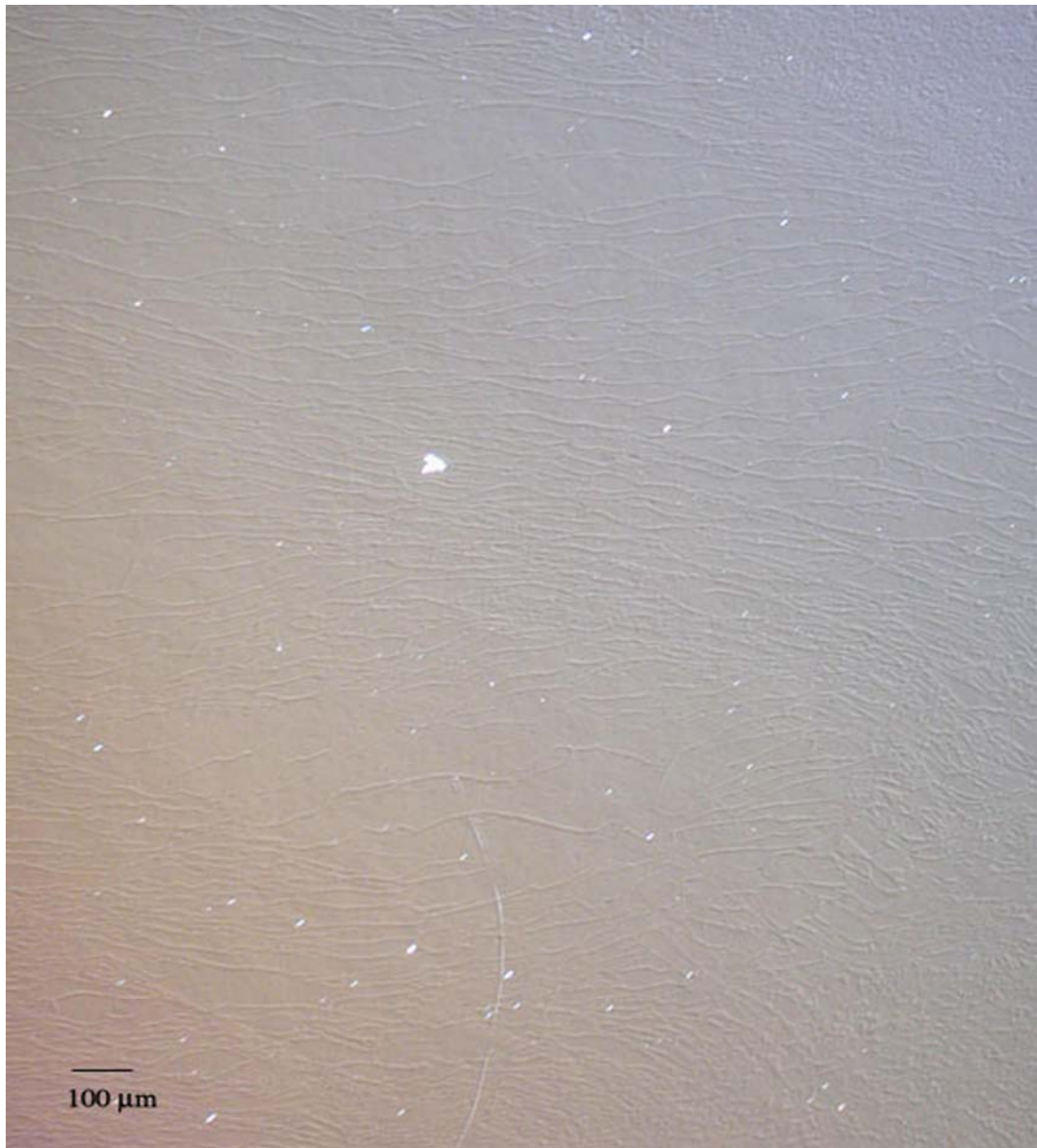
Abb. 30: Kontrastmikroskopische Aufnahme eines Films aus \text{Au}_{55}(\text{T}_8\text{-OSS-SH})_{12}\text{Cl}_6 auf einem Si-Wafer. (Übertragen mit einer Geschwindigkeit von 1 mm/min, Übertragungswinkel 90^\circ , Temperatur 20^\circ\text{C} ).
