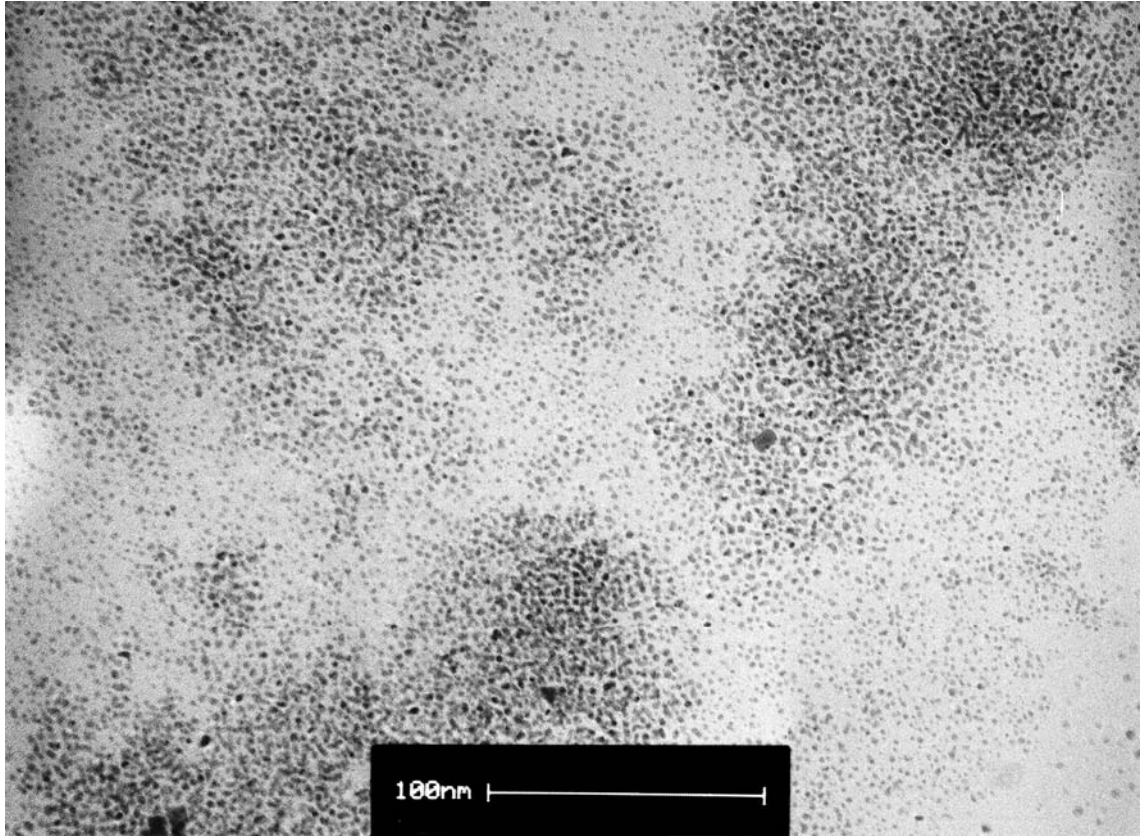
Abb. 46: TEM-Aufnahme eines Films aus \text{Au}_{55}(\text{PPh}_3)_{12}\text{Cl}_6 . (Übertragen mit einer Geschwindigkeit von 1 mm/min, Temperatur 20^\circ\text{C} , \pi = 20 mN/m).
