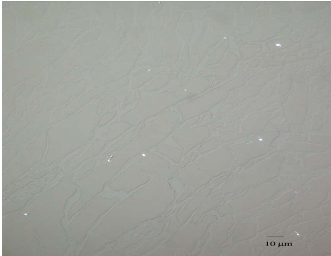
Abb. 64: Kontrastmikroskopische Aufnahme eines Films aus \text{Au}_{55}(\text{T}_8\text{-OSS-SH})_{12}\text{Cl}_6 , übertragen mit einer Geschwindigkeit von 1 mm/min. Übertragungswinkel 90^\circ , Temperatur 20^\circ\text{C} .
