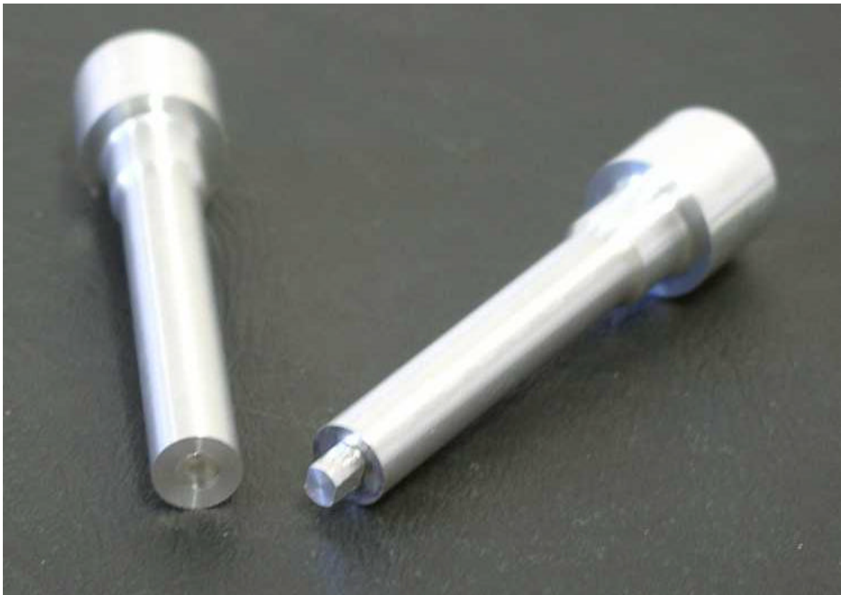
Abbildung B-1 Zugprobekörper aus AlMgSi1 (ungefügter Zustand)
