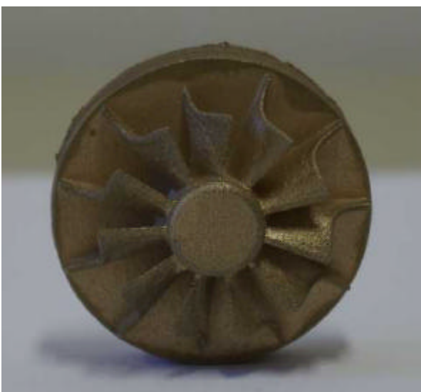
Abbildung B-3 Miniaturturbine gefertigt mittels Lasersintern (Metallpulver)
