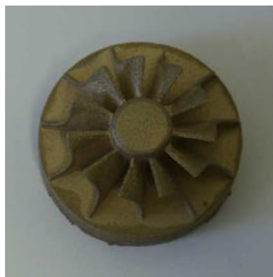
Abbildung B-3 Miniaturturbine gefertigt mittels Lasersintern (Metallpulver)
