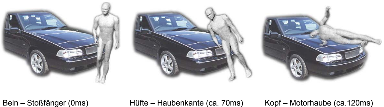
Abb. 2.8: Typische Kontaktphasen eines seitlich angefahrenen Fußgängers bei ca. 40 km/h
